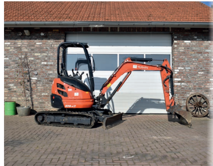
Kubota 2T 2180 kg. Binnendraaier Snelwissel CW05
